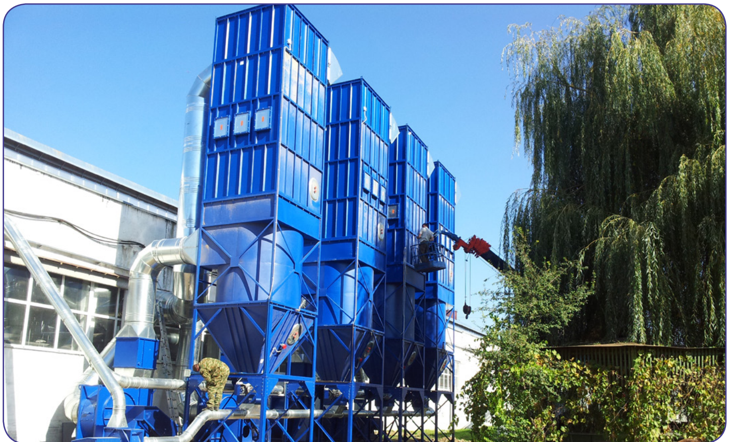
Система аспирации L = 122\ 000 м 3 /час. Рукавные фильтры с вибровстряхиванием ФР-32 - 4 шт. Компания Апшеронский Лес, г. Апшеронск
